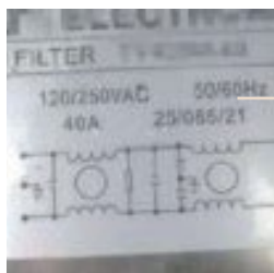
Système CEM Compatibilité électromagnétique Protège des autres ondes électromagnétiques
